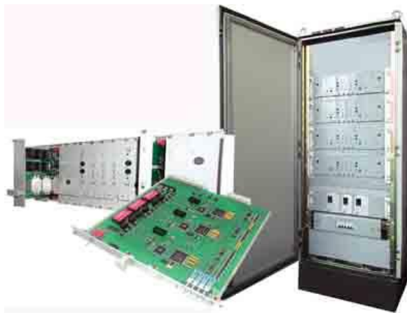
Блок управления стрелкой. Один блок обеспечивает управление одной стрелкой, включая силовую коммутацию привода. Блок представляет собой в цифровой части троированное устройство с резервированием аппаратуры силовых цепей
