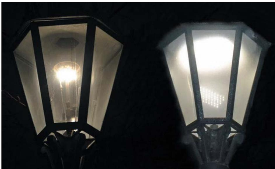
Рис. 4. Газонакалильный (слева) и светодиодный фонари
