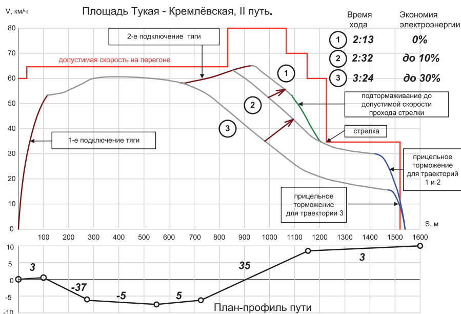
Рис. 1. Графики прохождения перегона «Площадь Тукая» — «Кремлевская» по 2-му пути для различных времен хода
